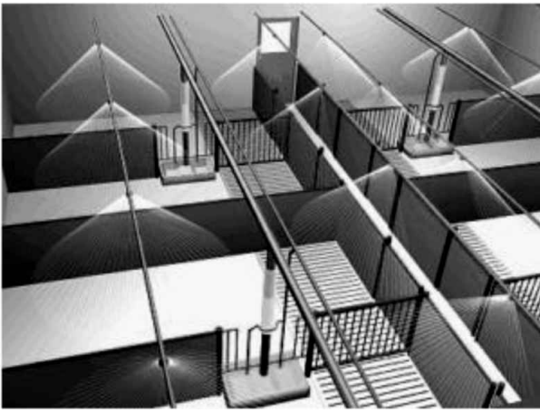
Figura 5.6 Instalație de pulverizare a apei
