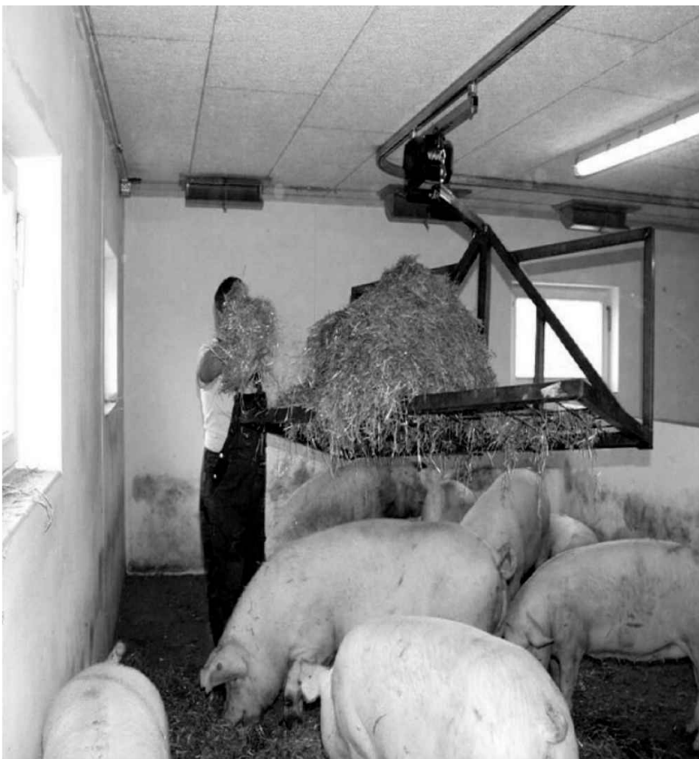
Figura 2.9 Distribuire automată a paielor
